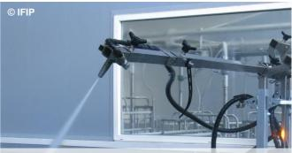
Orientation des buses haute pression à 300° pour le lavage du plafond (optionnel)
