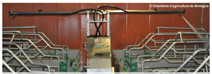
Robot roulant, fonctionnant généralement sur batterie, équipé d'un ou de deux bras, articulés ou non selon les modèles
